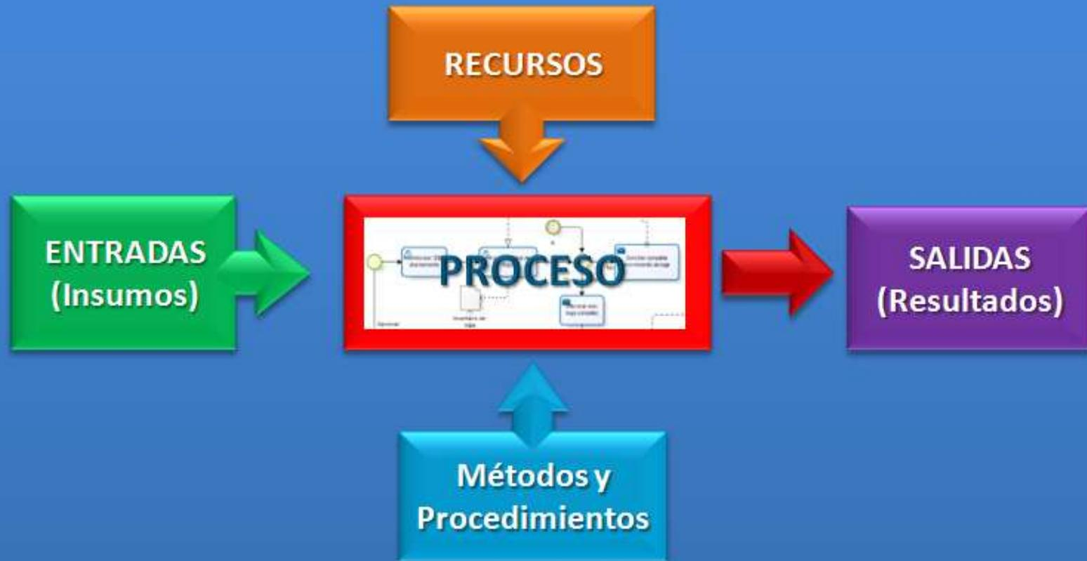
El análisis de sistemas es una técnica en la que se estudia el sistema mediante su descomposición en los procesos que lo conforman, y estos a su vez están compuestos por los siguientes elementos: entradas, insumos, procesamiento o transformador, salida o resultado (output); con una etapa transversal de retroalimentación (feedback).
