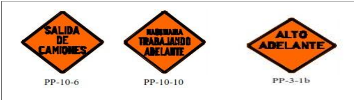
Figura 5. Señales de Prevención
